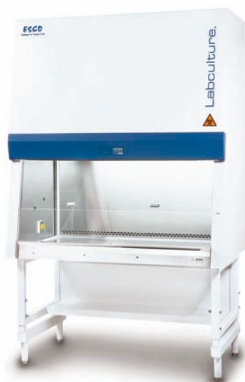
Рис. 2. Бокс биологической безопасности, класс II тип A2 (Labculture LA2-4A1)
